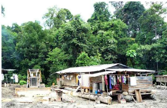
Anap-Muputの伐採現場の労働者用バラック(丸太の上に家が作られており、伐採地の移動にあわせて、ブルドーザーで牽引して家ごと移動できるようになっている)
