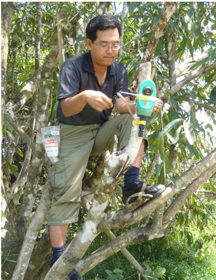
写真 3: 河岸モニタリング用カメラの設置 (Kemena 川)
