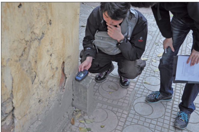
モバイル GPS 較正キットによるタンロン城壁の測量 DGPS measurement of the wall with mobile GPS calibration kit.
