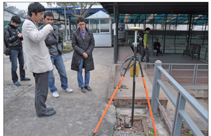
タンロン宮城測量基準点の GPS スタティック測位の講義 Lecture about the grand control point survey with static method
